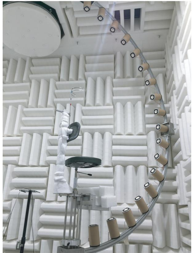
図-3 防音シールド室 (4.5 m×3.9 m×4.1 mH) に設置された頭部伝達関数測定系（椅子が360度回転することにより，全方向の頭部伝達関数が可能）
