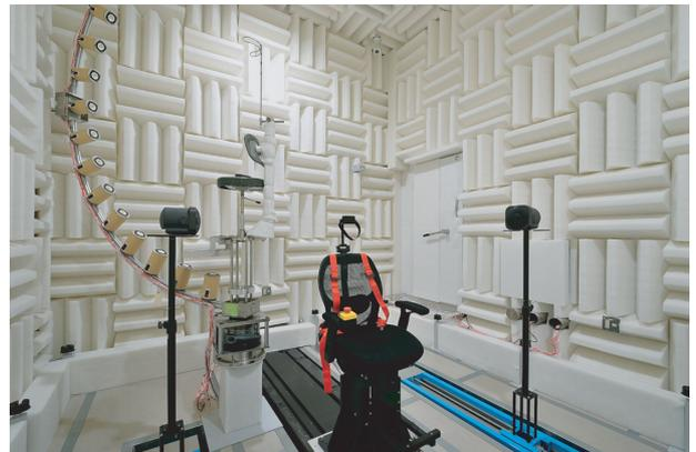
図-4 防音シールド室に設置された加速度運動提示用リニアアレイ（椅子とスピーカの両者が独立に静穏で動作）
