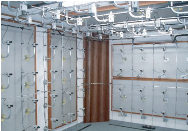
図-2 157 ch 包囲型マイクロホンアレイ (東北大学電気通信研究所)
