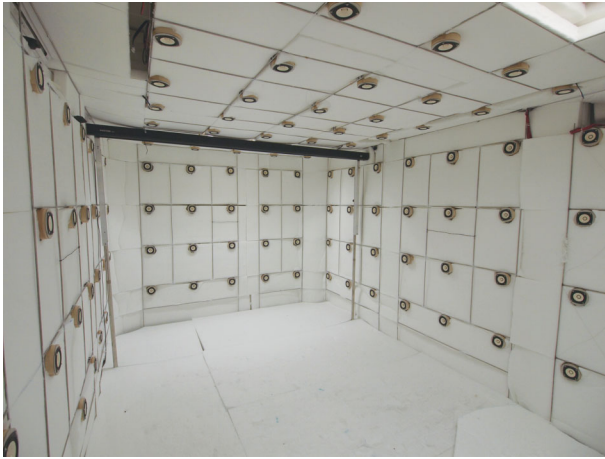
図1 東北大学電気通信研究所に設置された157chスピーカアレイ 次数5次(2014年まで世界最高)の高次アンビソニックスによる音場再現, 合成が可能。
